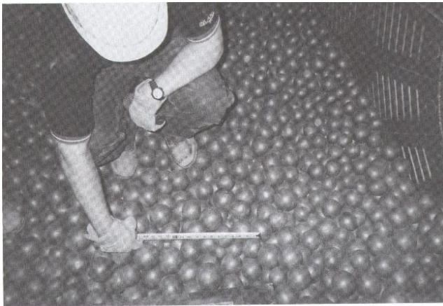
Resim 3- Bilyalı değirmende birinci kamarada öğütme bilyalarının çap ölçümü
