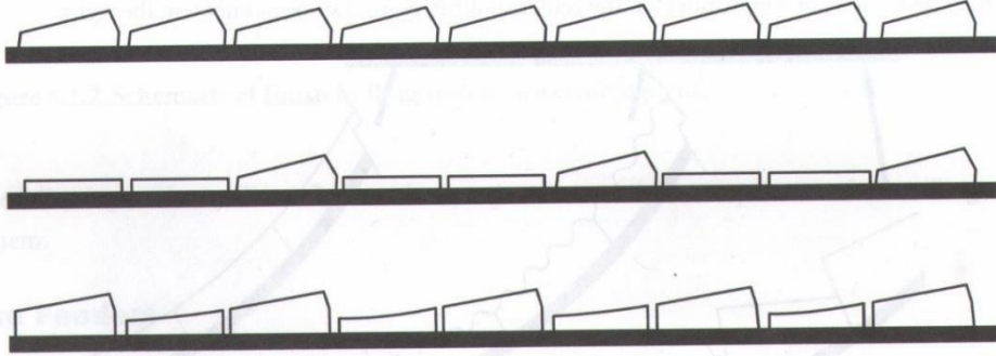
Şekil 9- Bilyalı değirmenin ikinci kamarasında kullanılan astar plaka kesitleri
