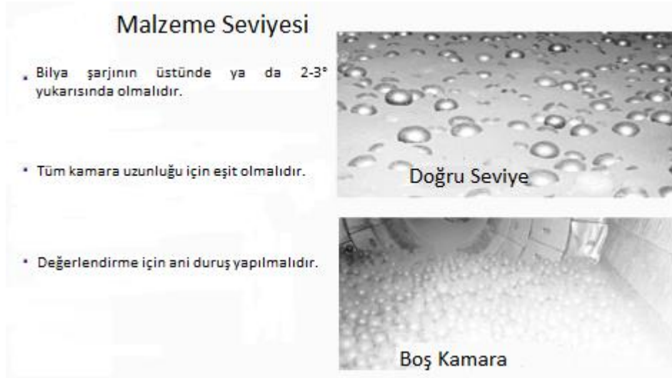
Şekil 15- Bilyalara göre doğru malzeme seviyesi
