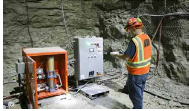
Resim 3. Monitörler, valfler ve takviyeler erişilebilir kabinlerdedir, bu nedenle sistemin muayenesi ve bakımı kolaydır. Figure 3. Monitors, valves and boosters are in accessible cabinets, so the system is easy to inspect and maintain.
