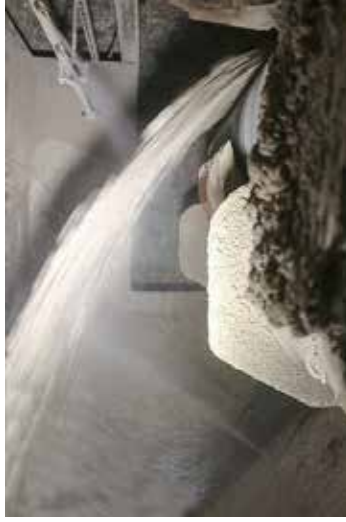
Resim 1. Toz yönetim sistemi malzemeyi tahliye sırasında üstten ve alttan şartlandırıyor.
