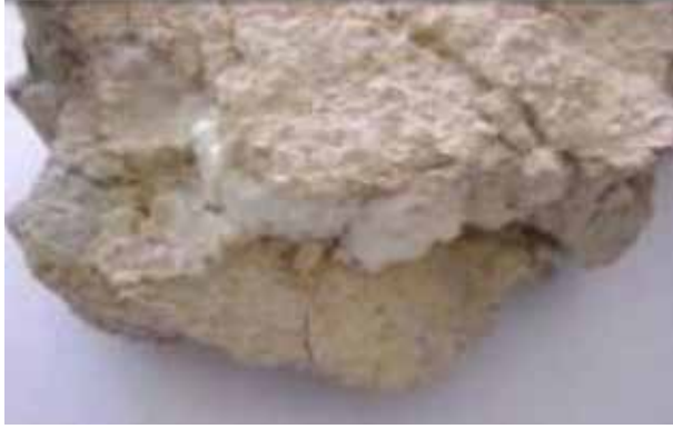
Şekil 6. ZrO_2 katkısı olmayan refrakterlerde hacim genişmesi [4] Figure 6. Bursting effect in no ZrO_2 additives refractories [4]
