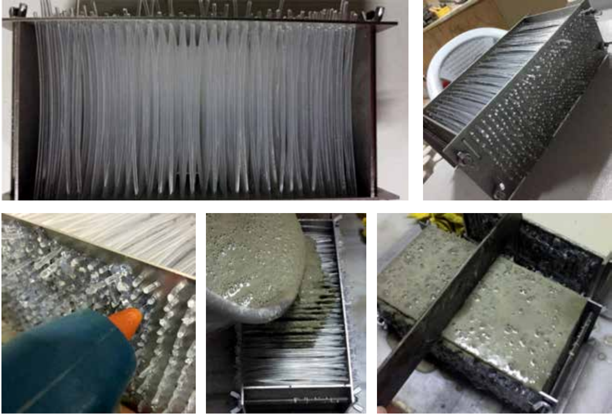
Şekil 4. Şeffaf beton üretim süreçleri Figure 4. Production phases of transparent concretes
