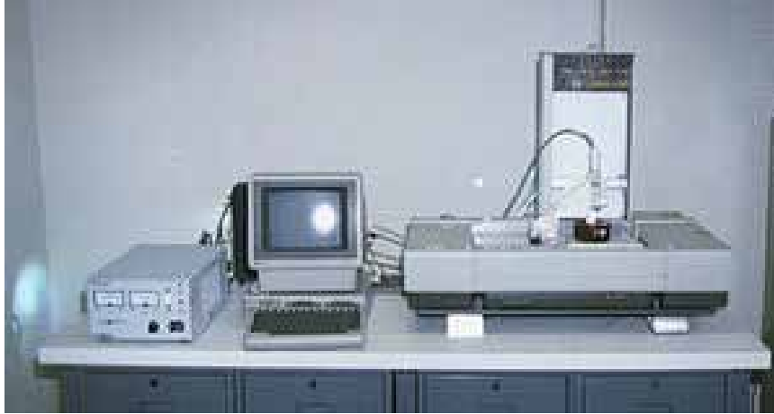
Charles Hull tarafından geliştirilen ilk 3B yazıcı, SLA First 3D printer developed by Charles Hull, SLA
