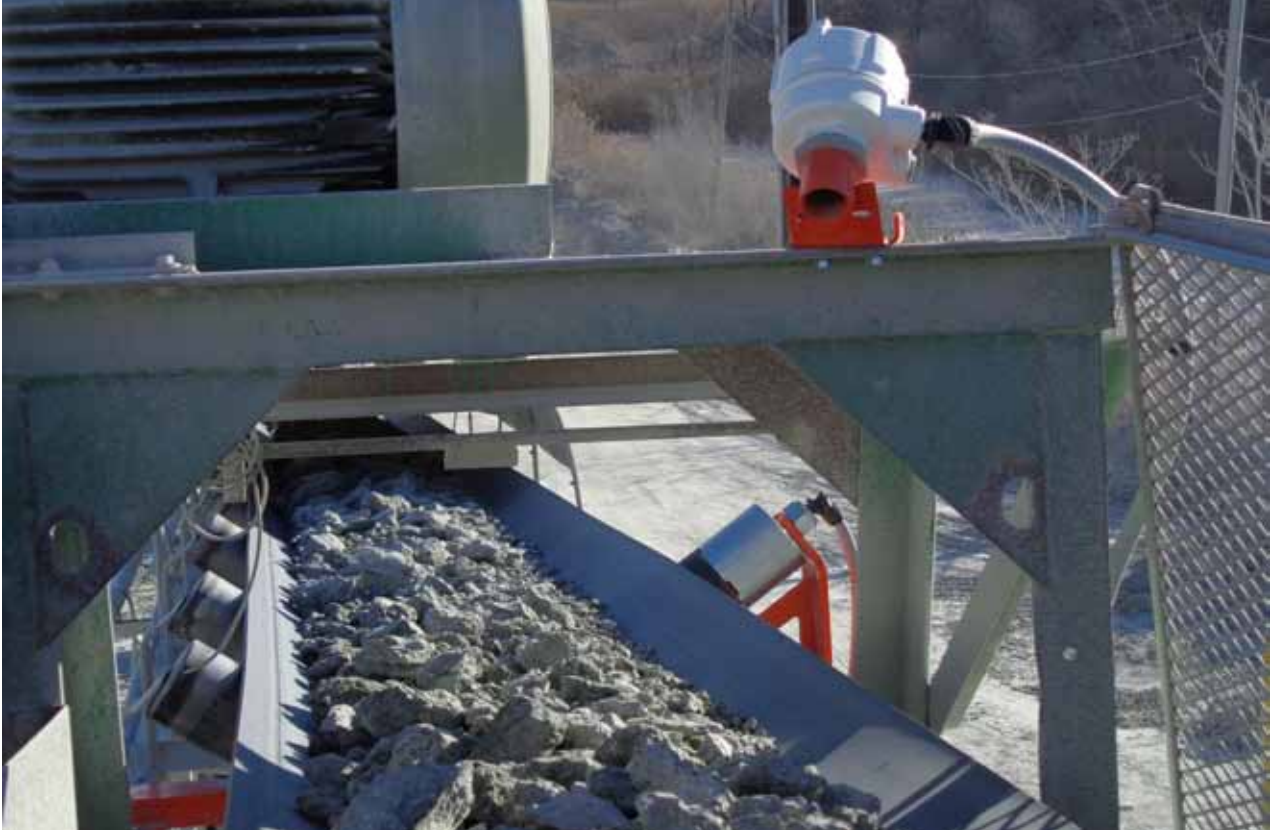
Sensörler, merkezi bir kontrol sistemine gönderilen verileri toplar Sensors collect data that is sent to a centralized control system.
