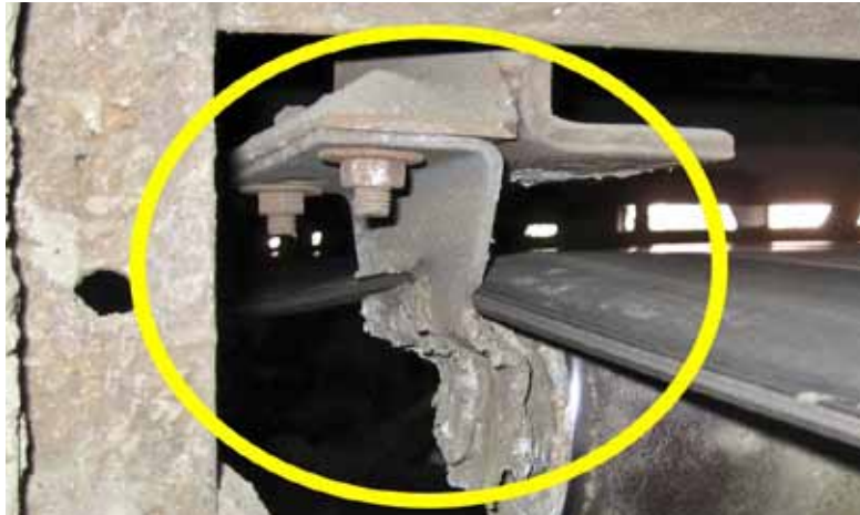
Bir rulo braketini kesen eksenden kaymış konveyör bandı. A mistracking conveyor belt cutting through a roller bracket.
