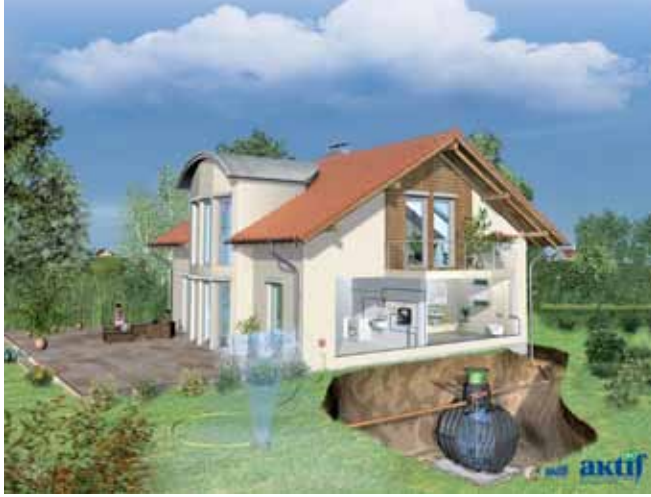
Şekil 2: Şematik bir yağmur toplama sistemi [http://www.aktifcevre.com.tr]
