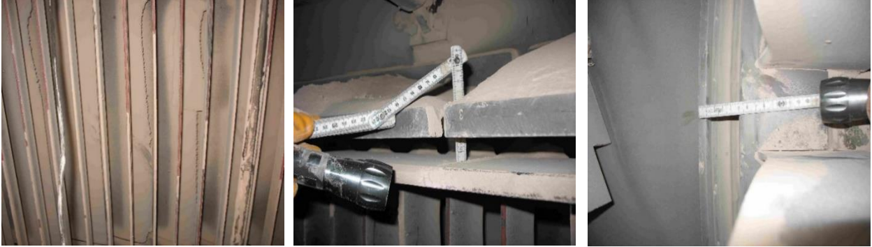
Resim 25- Separatör kanatları ve mesafe ölçümü
