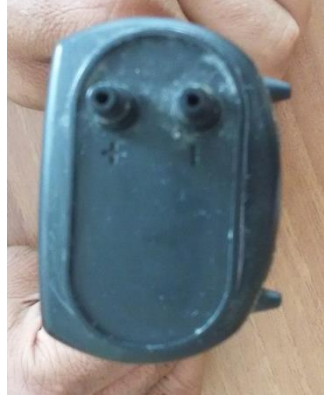
Resim 3- Basınç ölçüm cihazlarındaki (+) ve (-) girişler
