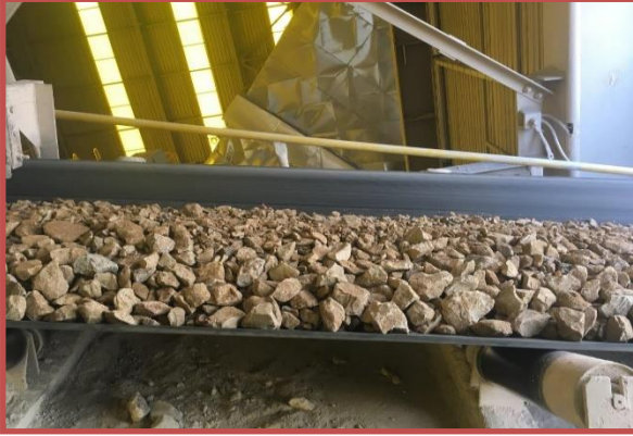
Resim 1a- Hammadde bandı üzerinden numune alma
