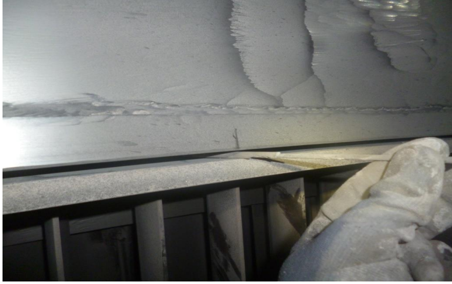
Resim 27- Separatör hareketli parça ile kanat üstündeki sabit yüze olan boşluk
