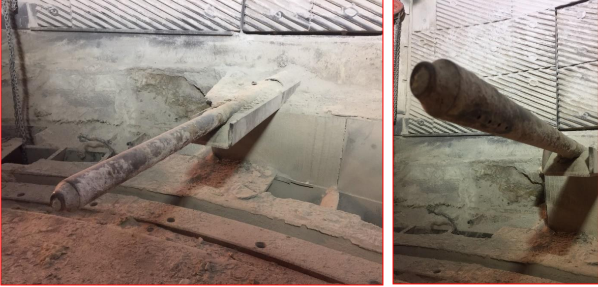
Resim 26- Deęirmen içi su püskürtme sistemi
