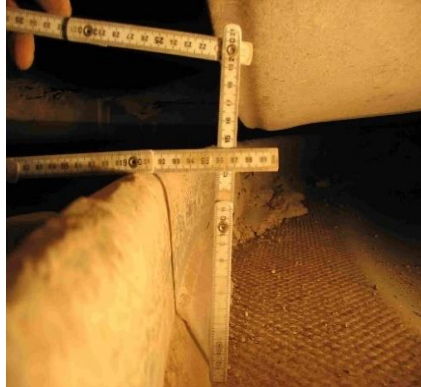
Resim 17- Çevresel dam ring yüksekliği ölçümleri
