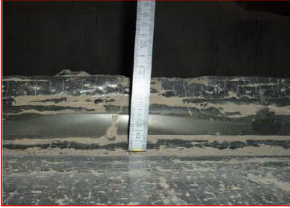
Resim 15- Dam ring yüksekliği ölçümü
