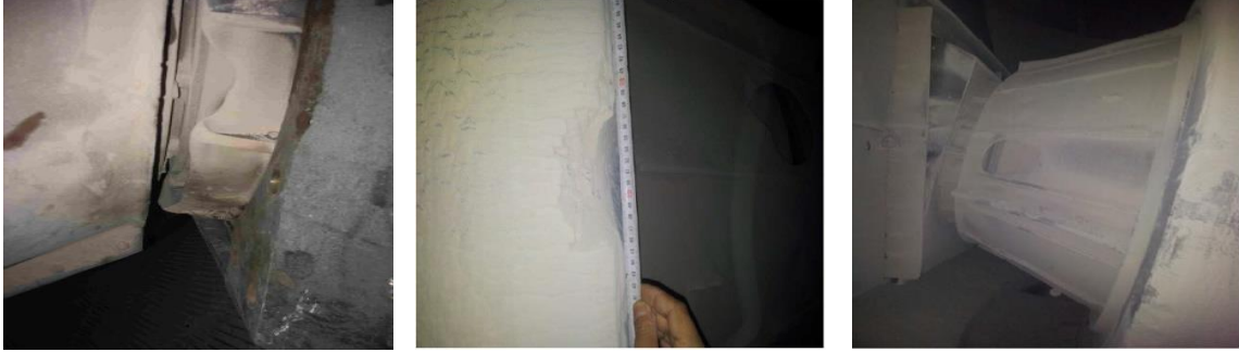
Resim 9- Vals aşınma kontrolleri
