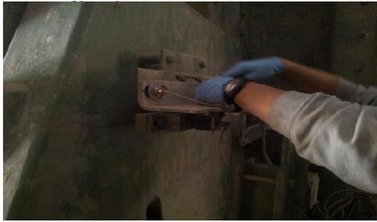
Resim 18- Tabla ile vals arasındaki mesafe ölçümü
