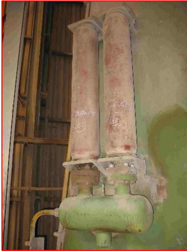
Resim 21- Vals pistonu akümülatörleri
