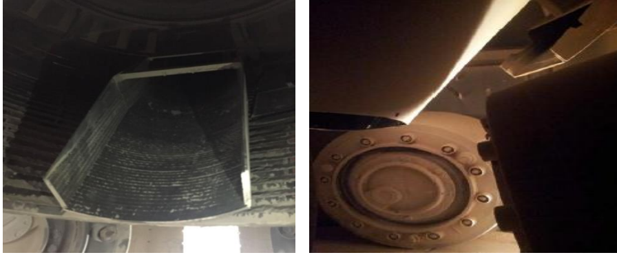
Resim 20- Geri dönüş konisi ve taze besleme şutu
