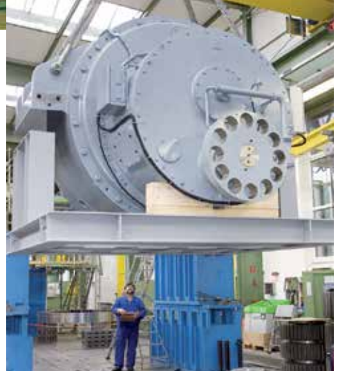
Yatay çimento değirmeni için PBLZ 225 tipi redüktör Güç: 6300 kW
