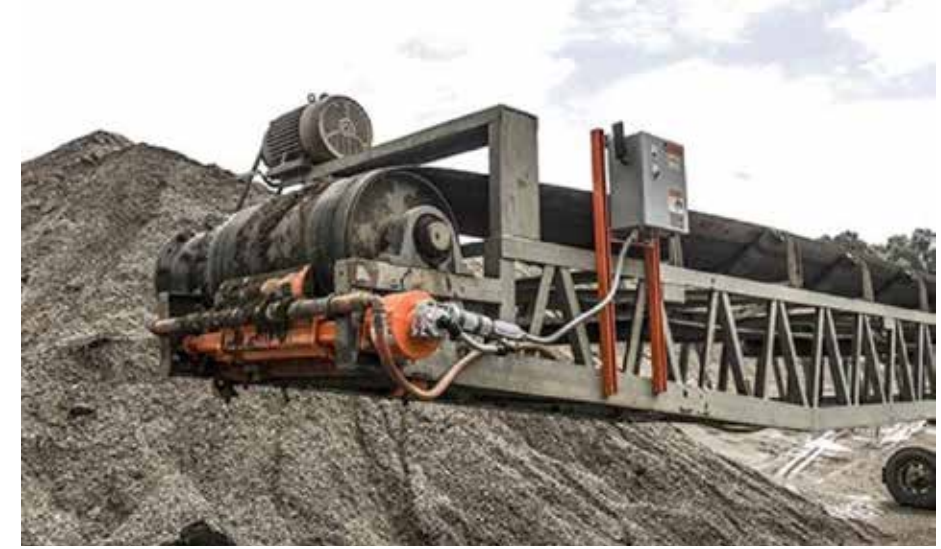
Yeni tasarımlar, bant gerginliğini bile kontrol edebilir ve ucu boş bir banttan uzaklaştırabilir. New designs can even control belt tensioning and pull the blade away from an unloaded belt.
