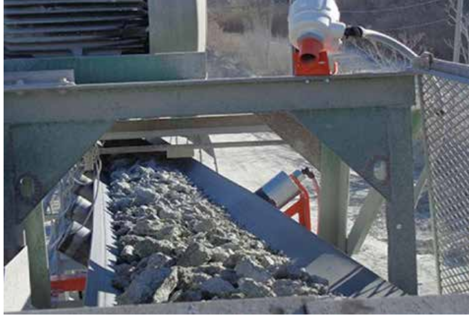
Bir bant üstü analizörü diğer ekipmanlarla iletişim içerisinde gerçek zamanlı performans verileri sağlayabilir. A cargo monitor can provide real-time performance data & communicate with other equipment.
