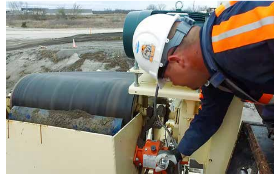
Bir teknisyen, bant sıyırıcı gergisine bir Pozisyon İzleyici takıyor. A technician installs a Position Indicator on a belt cleaner tensioner.
