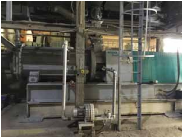
Şekil 10. Bursa 1. Çimento Hattına ilave edilen boncuk bilyalı değirmenin fotoğrafı ve teknik özellikleri
