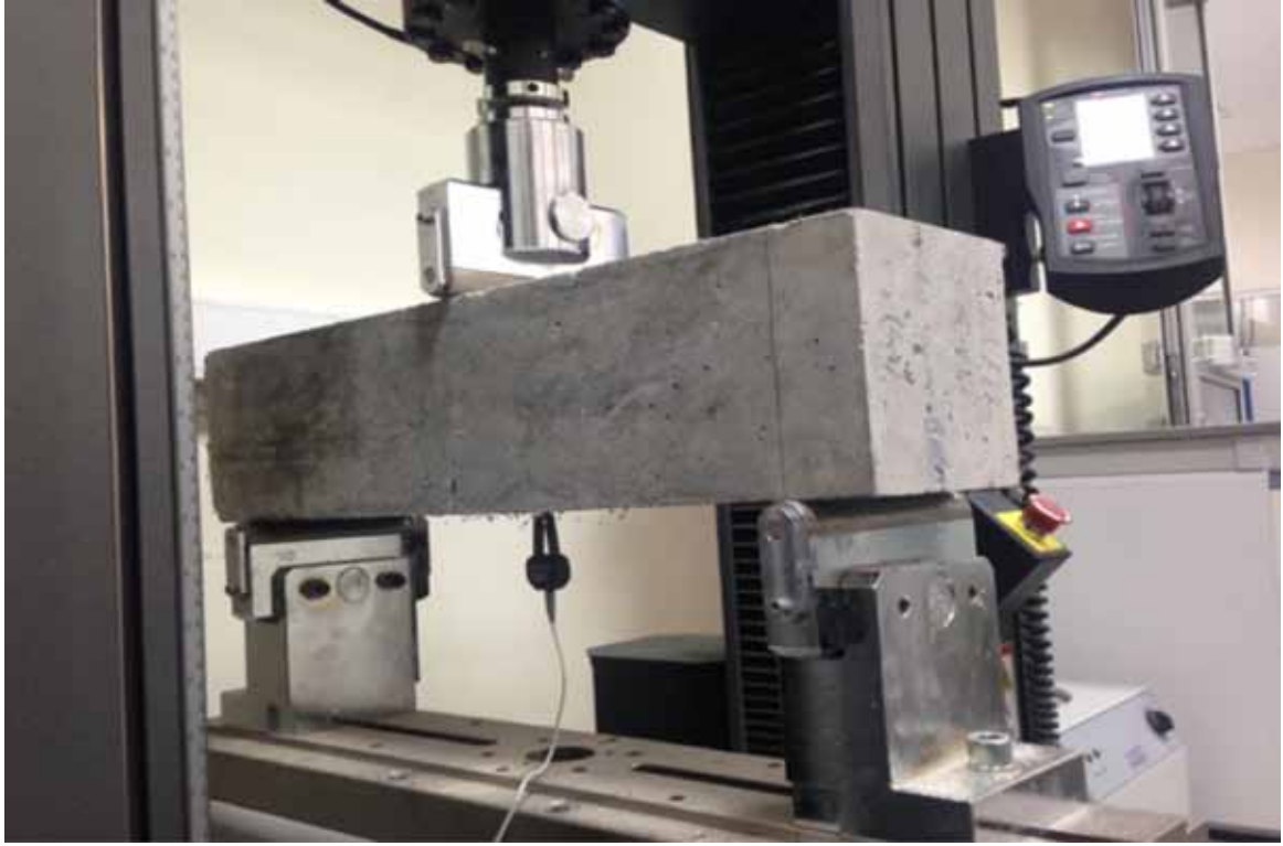
Şekil 3: EN 14651 Test Düzeneği / Figure 3: EN 14651 Test Machine
