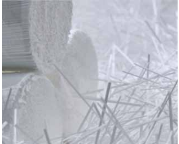
Şekil 1: Makro Sentetik Lif / Makro sentetik fiber donatı/ / Figure 1: Macro Synthetic Fiber Reinforcement
