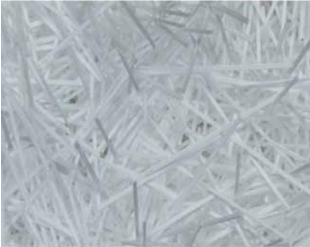
Şekil 1: Makro Sentetik Lif / Makro sentetik fiber donatı/ / Figure 1: Macro Synthetic Fiber Reinforcement
